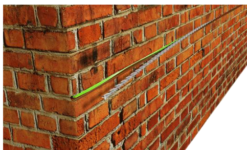
Obrázek 38 – Vložení prutu helikální výztuže do malty v drážce
