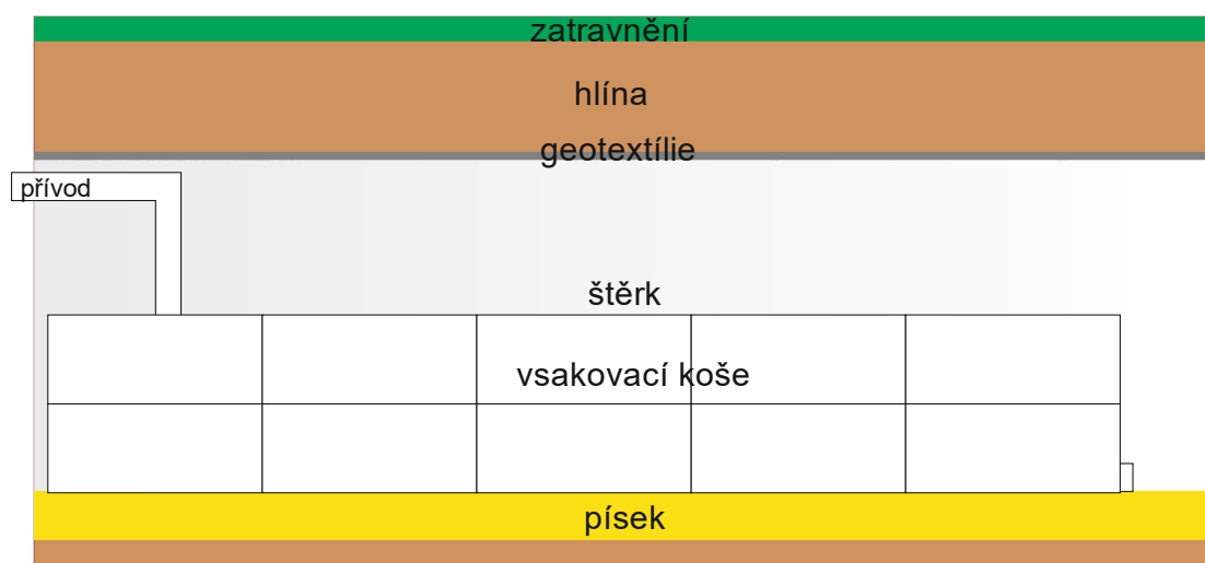
Obr. č. 31. Návrh vsakovacího drénu
