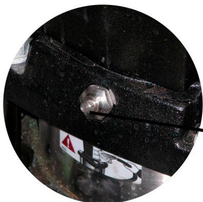
Odvzdušňovací šroub elektrického čerpadla chladicí vody
