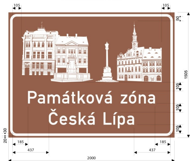
Grafika z retroreflexní fólie RA2. Nosná konstrukce: příhrady
