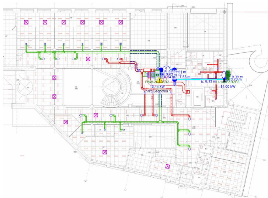
Obr. 29: Půdorys 1.NP – vzduchotechnika – převzato ze schématického návrhu.
